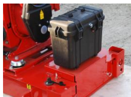
Skrzynka narzędziowa, pokrywa i rozłącznik akumulatora
