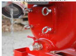
Zawór do spustu wody oraz duża komora rewizyjna
